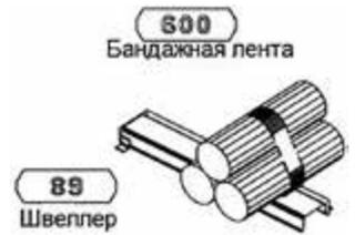
Три кабеля 500 кВ, связанные бандажной лентой Р-162 в 5 слоёв, лежащие в лотке без закрепления на поперечной металлоконструкции из швеллера (узел 89)
