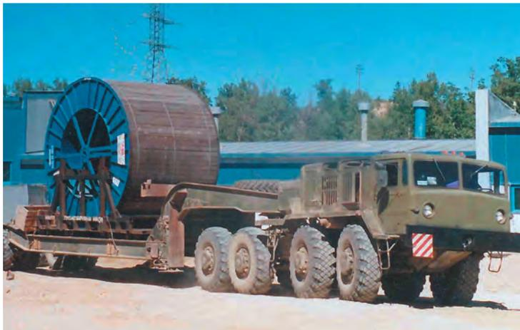
*Рис. 1. Металлический барабан с кабелем 500 кВ на прицепе автомобиля «Ураган», закреплённый на транспортной металлоконструкции*
