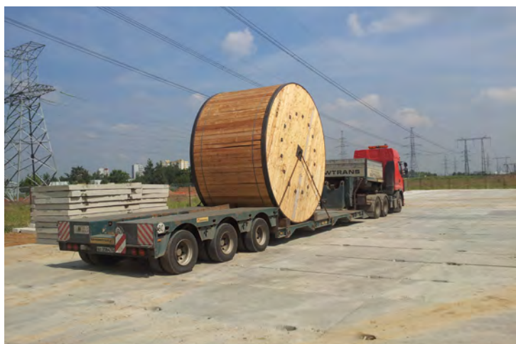
Рис. 17. Транспортировка одного барабана с кабелем 500 кВ на специальном автомобильном прицепе
