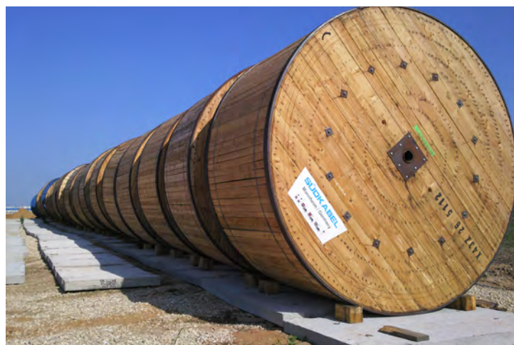
Рис. 20. Барабаны с кабелем 500 кВ на площадке для хранения
