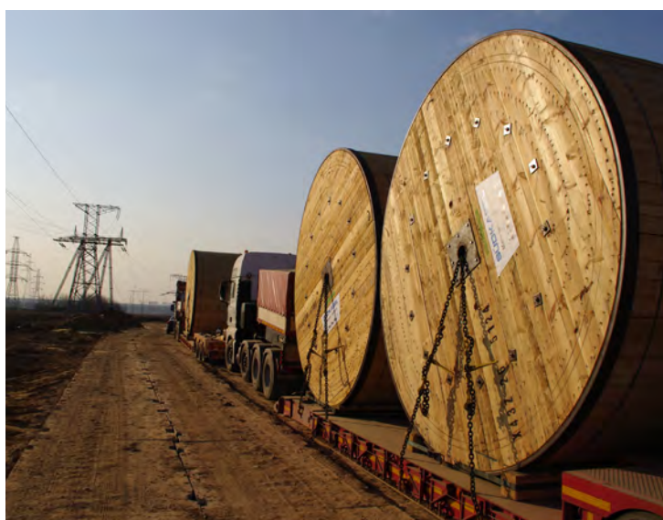
Рис. 18. Транспортировка двух барабанов с кабелем 500 кВ на специальном автомобильном прицепе
